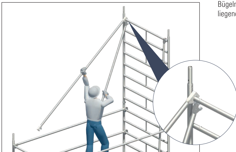
8. Demontage der Geländer 14 durch öffnen der Einrastklaue mithilfe von einem der unter 3. demontierten Zwischengeländer. Das lose Geländer 14 wird auf die 2. Sprosse von oben aufgelegt und wirkt als Hebel zum Öffnen des Schließbügels der Einrastklaue (siehe Detail).
