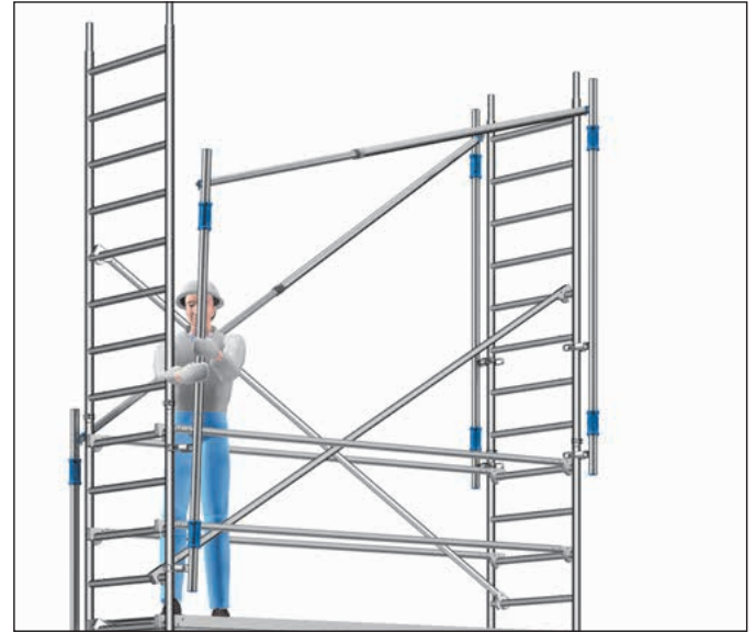
Bild 5: Versetzen des MSG nach oben
