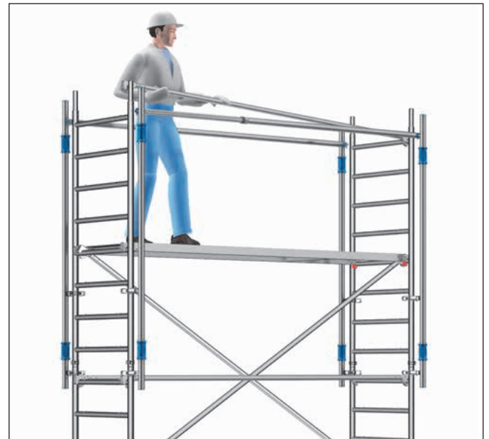
Bild 6: Sichere Montage der Rückenlehnen mit MSG
